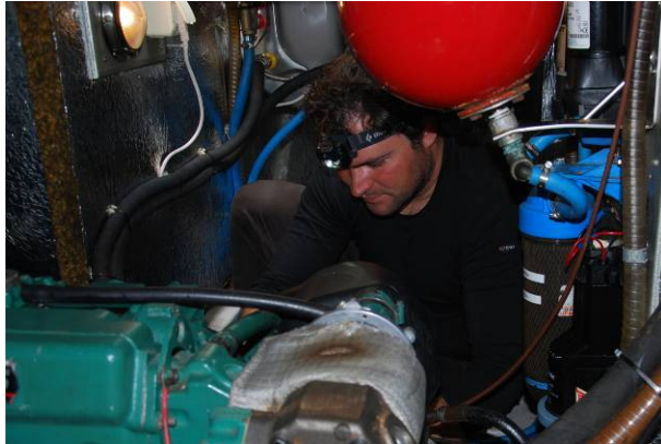
DSC_6341a.jpg, André tief im Motorraum beim Ölwechsel.
